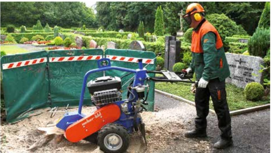
*Eine besondere Gefährdung geht von dem drehenden Fräswerkzeug aus. Des Weiteren ist der vom Hersteller vorgegebene Sicherheitsabstand einzuhalten.*
